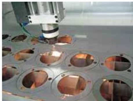
Der Stand-alone-Lasercutter eignet sich vor allem für die Fertigung von Prototypen oder Kleinserien.
