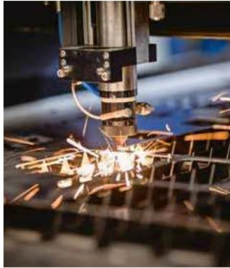
Beim Metallschneiden auch bei kleineren Stückzahlen oder der Prototypenfertigung auf Lasertechnik zu setzen, hat in der Praxis viele Vorteile.
