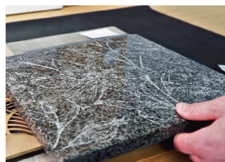
/ Auch mineralische Materialien wie Stein lassen sich mit einem CO 2 -Laser bearbeiten. Das gilt auch für Mineralwerkstoffe, also Verbundstoffe, wie z. B. Corian.
