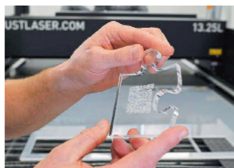
/ Ob Logo, Aufschrift oder QR-Code, Acryl lässt sich wunderbar gravieren und schneiden. Bei gegessenem Acryl (GS) entsteht dadurch eine Milchglasoptik.
