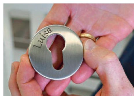
/ Ist man mit einem Faser-Laser oder supergepulsten Lasern unterwegs, können auch Metalle bzw. anorganische Materialien graviert und geschnitten werden.
