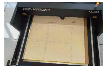
/ Wie bei einer Nesting-CNC kann ein Laser Platten formatieren/aufteilen. Zu beachten ist lediglich die Auflagefläche der Maschine. Hier: 1300 x 2500 mm.
