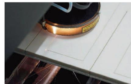
/ Bei der Laserbearbeitung fallen keine Späne an, da das Material unmittelbar verdampft. Der dabei entstehende Schmutz wird direkt abgesaugt.
