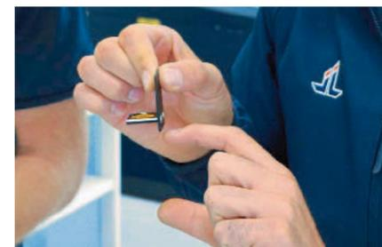
/ Durch die Linse selbst und den Abstand zum Material lässt sich der Laserstrahl in seiner Größe verändern, was sich direkt auf die Schnittfuge auswirkt.
