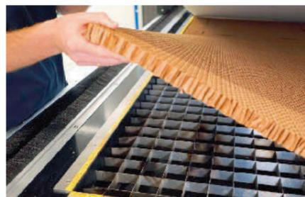
/ Laser arbeiten berührungsfrei, wodurch Spannvorrichtungen entfallen. Um stets saubere Schnittkanten zu erhalten, lässt sich die Auflagefläche wechseln.
